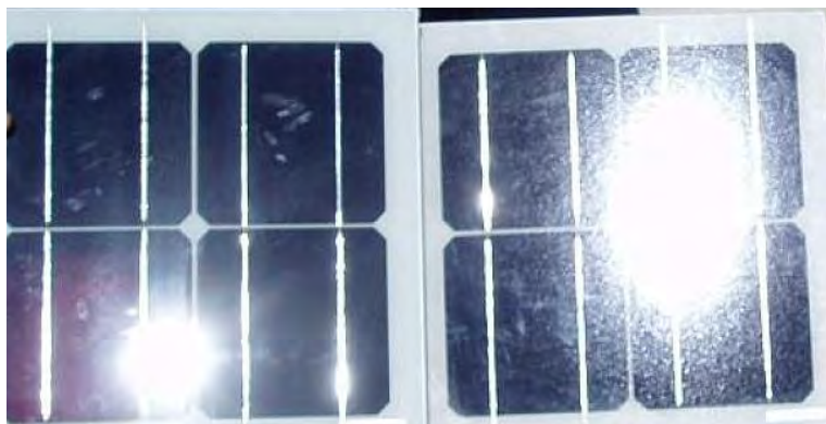
Bild 3.2.3: Diffuse Reflexion von unterschiedlichen Moduloberflächen (Quelle: Sandia National Laboratories, Ausschnitt)
