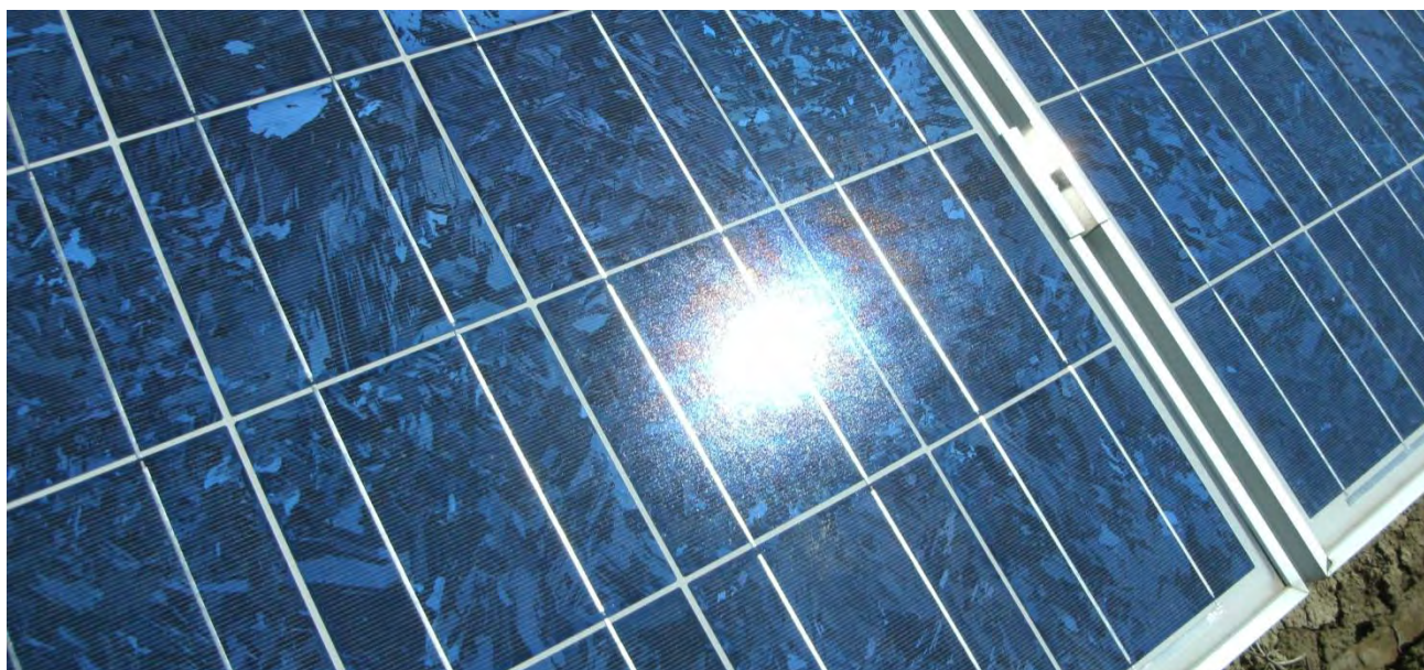
Bild 3.2.2: Diffuse Reflexion von direkten Sonnenlicht (Einstrahlung ca. 980 W/m²) auf einem PV Modul (Quelle: SolPEG)
